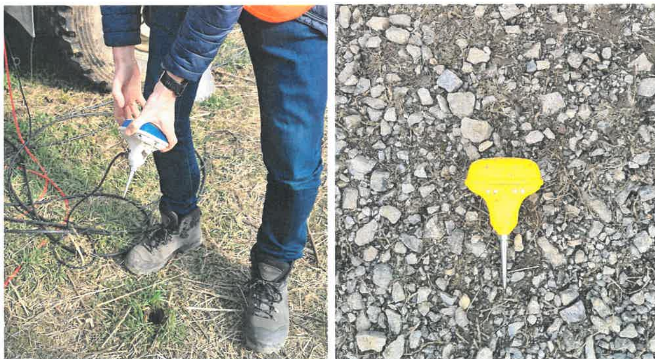
Slika 5. Prikaz geofona (prijamnika)
